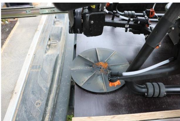
Abb. 1 oben: Aussaatdrohne mit 15 kg Nutzlast.
